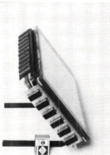
Fig. 5. De stuur-IC's zijn gemonteerd op flexibele gedrukte bedrading die aan alle vier de zijden rechtstreeks met de lijnen van de stuurplaat zijn verbonden. Daardoor maakt de hele elektronica deel uit van het beeldscherm zodat beide een compacte eenheid vormen.
