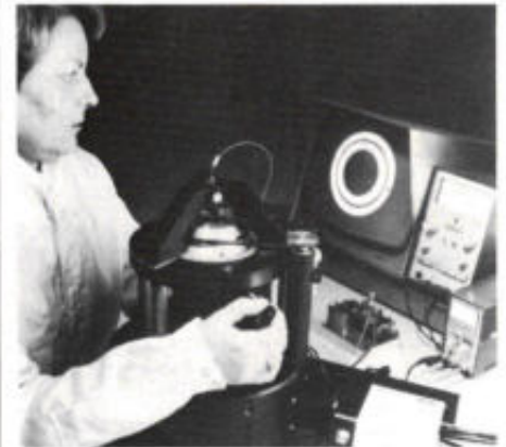
Afb. 2. Dankzij de optische controlemethode kan men in één oogopslag zien of de kern van de vezel exact op de draaibankas ligt. Daarvoor moeten de twee ringen op de monitor precies concentrisch zijn. Een getrainde operator kan op deze manier de kern centreren met een afwijking van slechts 0,05 \mu\text{m} (foto-nr.: 82.14.0657).
