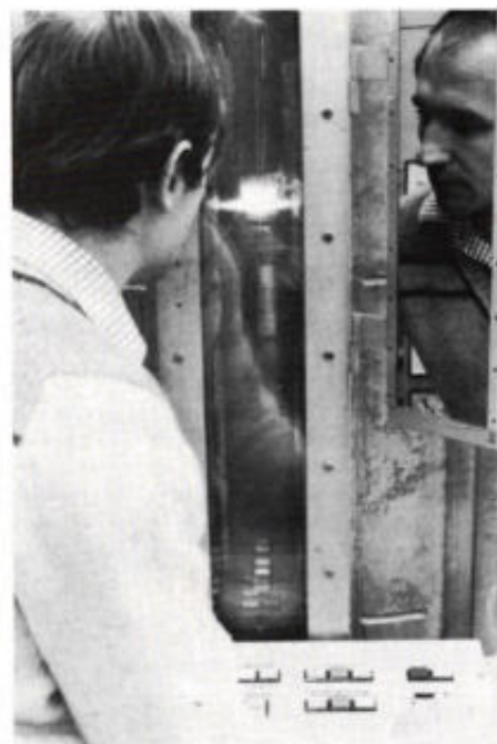
Afb. 2. Door een inductief verhitte smeltzone met een temperatuur van 1400 °C wordt de polykristallijn staaf omgezet in monokristallijn silicium met de hoogste zuiverheid. De smeltzone verplaatst zich met een snelheid van 4 mm per minuut langs de staaf. (foto Siemens).
